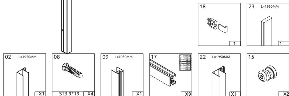
Placez le pare-chocs (18) et les rouleaux (15) dans le guide supérieur (17) et le vissez au profil vertical (22) avec les vis (08).
